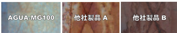
下地：SPCC 発錆板 試験内容：塩水噴霧連続 480 時間 試験層内：35℃×98%RH
