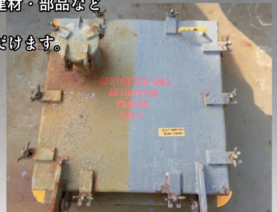
船舶の立入禁止区域のハッチカバー施工 左：未施工 右：SR200で除去
